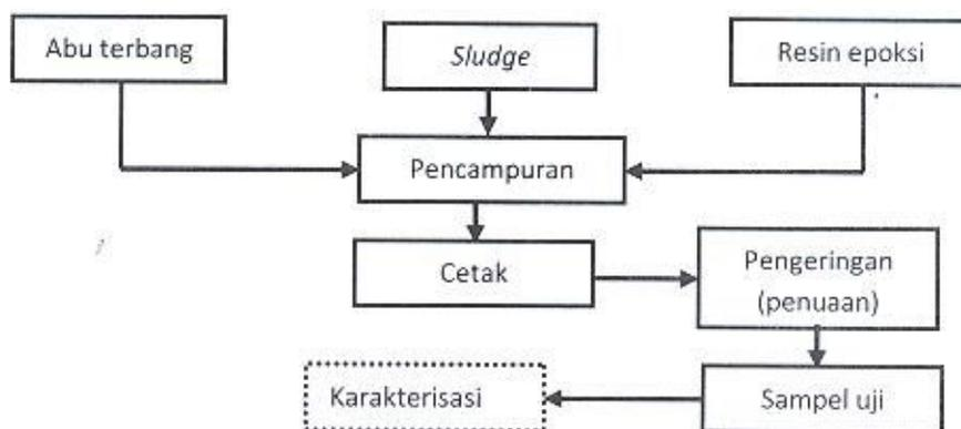
Gambar 1. Diagram alir pembuatan benda uji beton polimer
